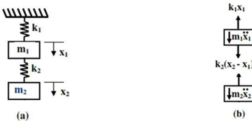
Gambar 5.3. Sistem tidak teredam satu tumpuan dengan dua derajat kebebasan
